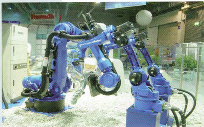
● Een handlingrobot en twee lasrobots aan het werk aan een auto-onderdeel. (Foto: Motoman Benelux)
